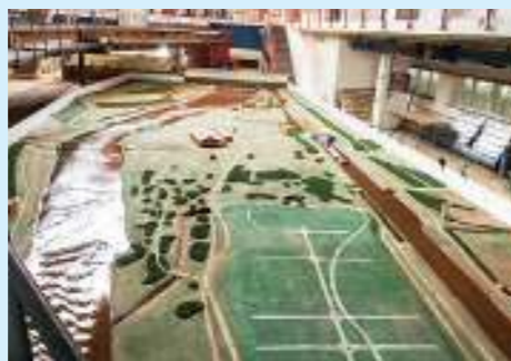
▲ Zaplavení Císařského ostrova při povodni lze simulovat na modelu
