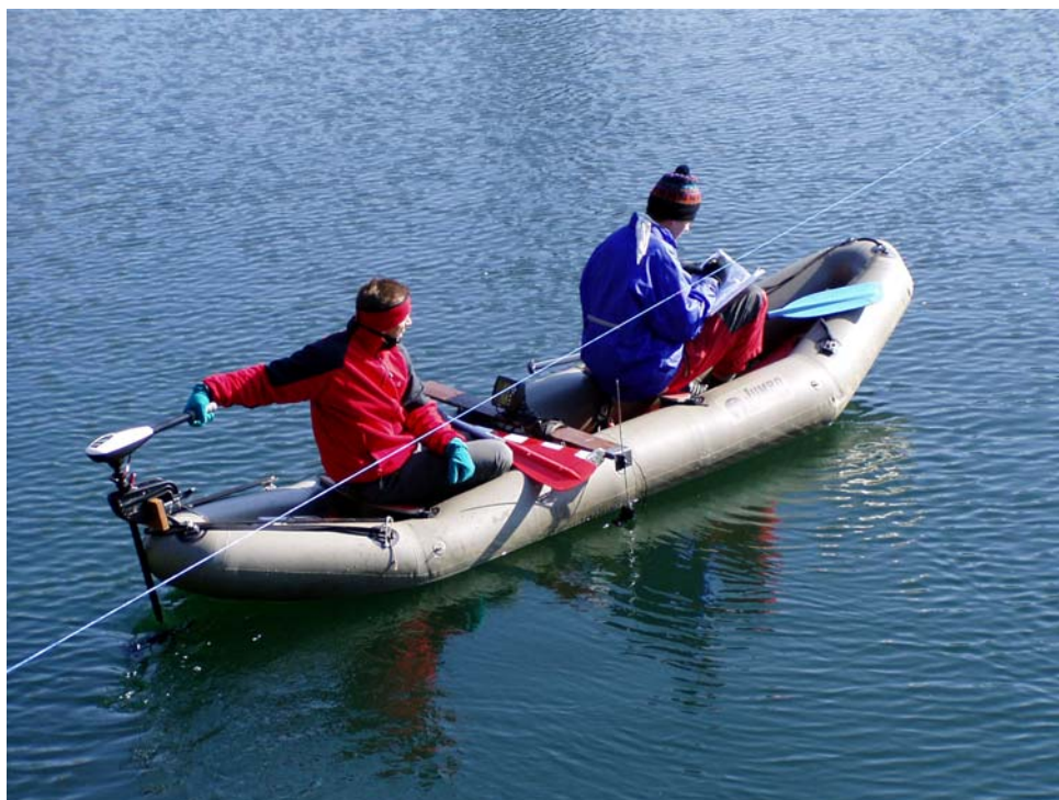
Foto 35: Měření hloubek echolotem Garmin na lokalitě Srní u Hlinska
