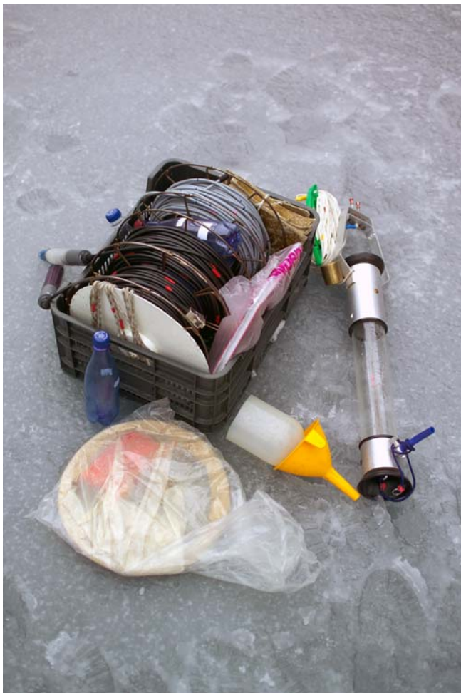
Foto 36: Přístroje používané k měření fyzikálních vlastností vody (v dolní části snímku Secciho kotouč a planktonní síť, napravo Van Dornův odběrný válec)
