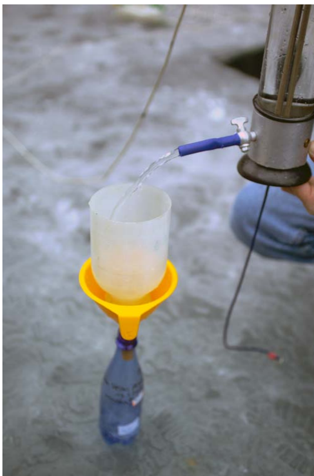
Foto 38: Zimní odběr hlubinné vody k chemickému rozboru (lokalita Amerika u Berouna)
